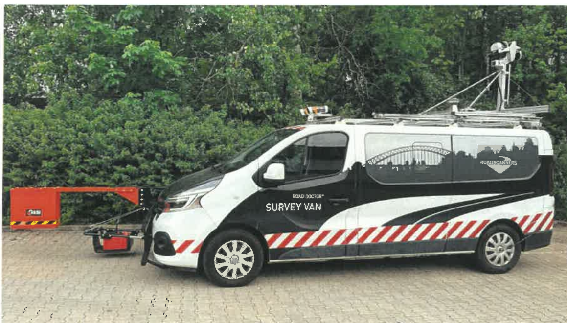
Obrázek 8. GPR měřicí systém společnosti Roadscanners CE vybavený 2 GHz “horn” anténou a 400 MHz ground-coupled anténou před vozidlem. Videokamera s GPS přijímačem a laserový skener jsou upevněny na střeše vozidla, 3D akcelerometr na zadní nápravě vozidla.
