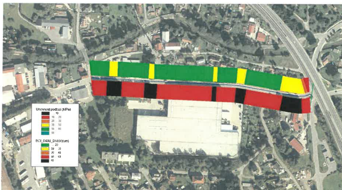
Obrázek 13. Hodnoty modulu podloží (nahoru, vpravo ve směru staničení) a BCI podkladového indexu křivosti (dolu, vlevo ve směru staničení) zobrazené na mapě.
