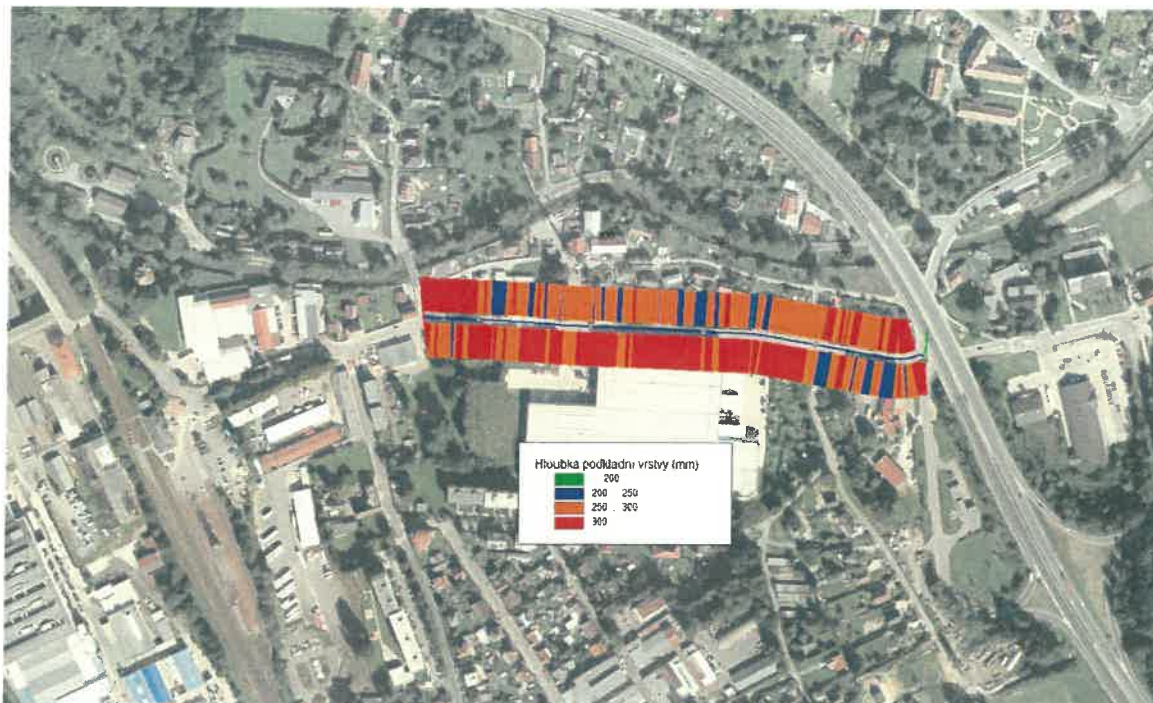
Obrázek 10. Tloušťka podkladních nestmelených vrstev v jednotlivých hodnocených liniích úseku (pravá, levá ve směru staničení) na mapě.
